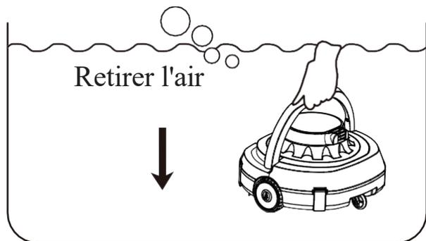
1. Appuyez sur le bouton marche/arrêt situé sous le robot jusqu'à ce qu'il s'allume. Maintenez le robot horizontalement sous l'eau pendant environ 20 à 30 secondes. Le robot doit couler librement jusqu'au fond de la piscine.
