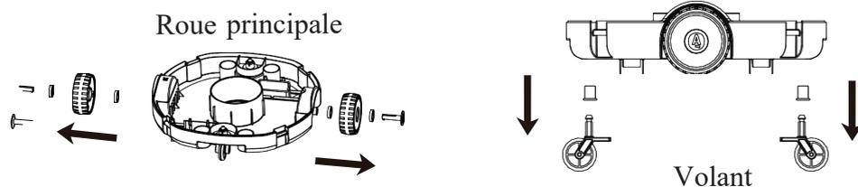
Remarque : la roue principale de ce côté est munie d'aimants. Veuillez contacter le revendeur pour le remplacement ou l'entretien.
