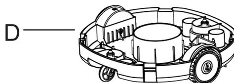
La tête de jet (A) tourne de 180 degrés tandis que l'eau s'écoule à travers la base inférieure (D), les filtres (C et B) et le couvercle supérieur.
