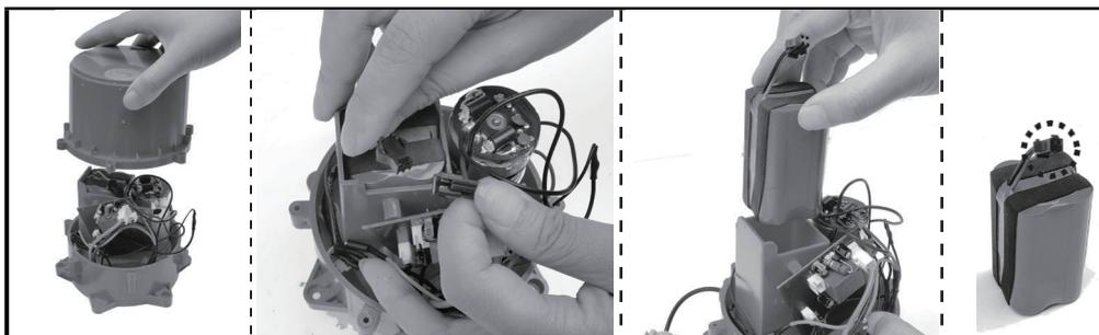
3. Ouvrez le couvercle de la batterie, trouvez la ligne de connexion de la batterie, appuyez sur le clip du connecteur, tirez-le et retirez la batterie.
