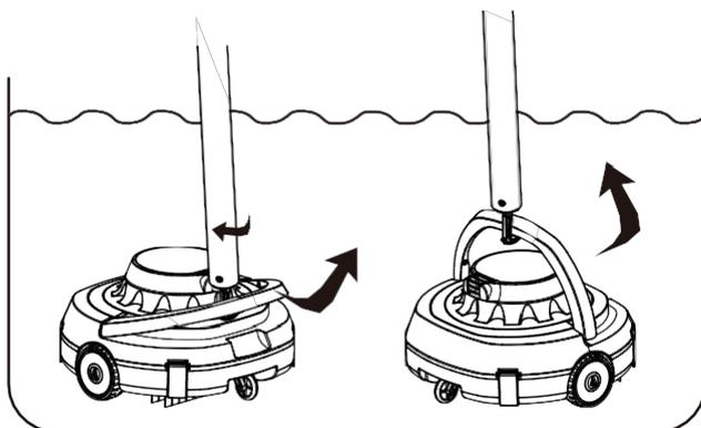
3. Si l'eau est profonde, le robot peut être accroché à un crochet.
